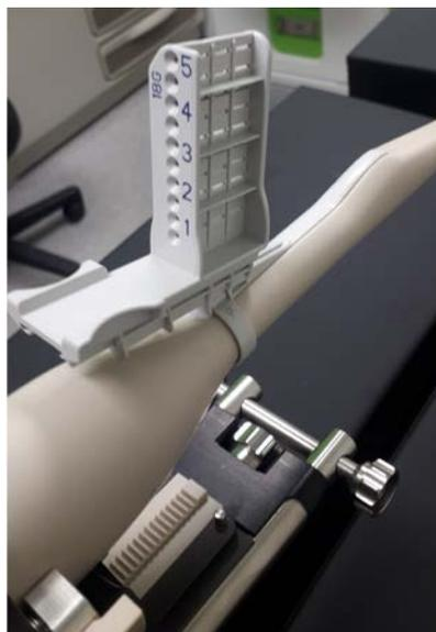
Figure 21 : EV29L avec le guide-aiguille transpérinéal stérile EV29L inséré (illustré sans gaine)
