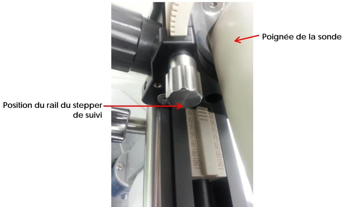
Figure 40 : Position du rail du stepper de suivi
