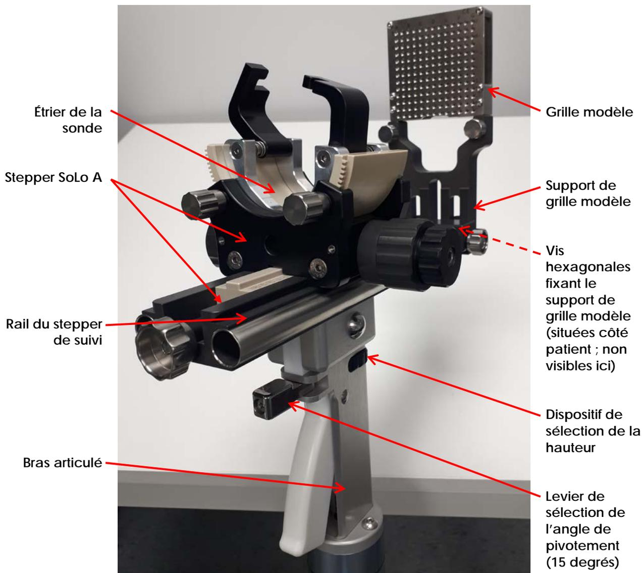
Figure 11 : Éléments du stepper transpérinéal qui doivent être désinfectés
