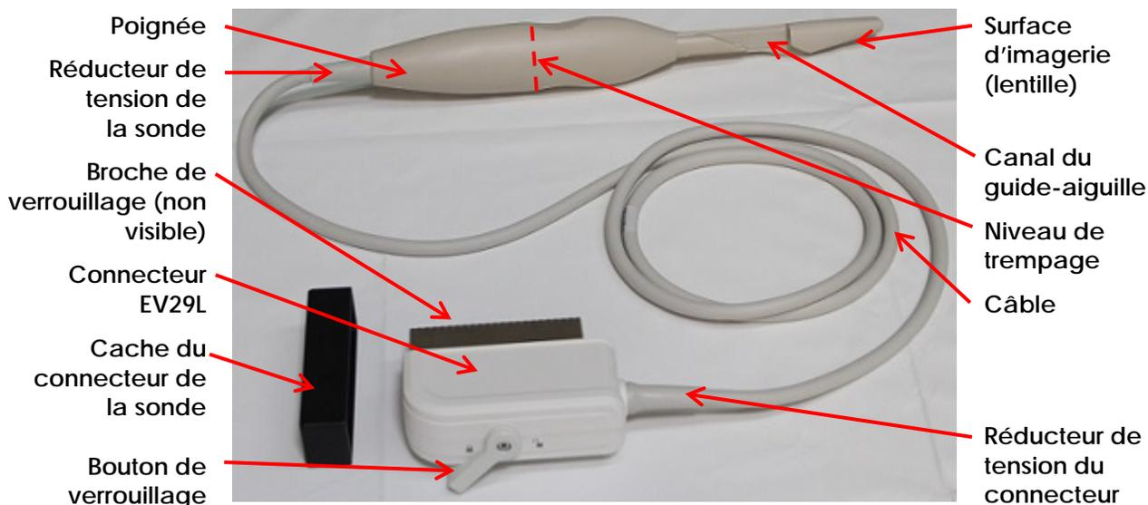
Figure 31 : Sonde EV29L ExactVu
