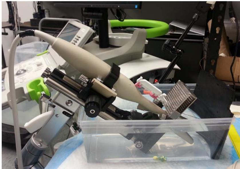
Figure 41 : Sonde et stepper transpérinéal dans le bain d'eau
