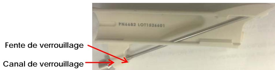
Figure 5 : Guide-aiguille transrectal réutilisable EV29L
